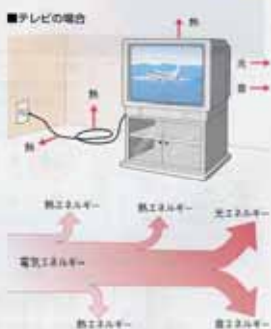
図16 電気エネルギーの移り変わり。音や光、熱など、一部は熱エネルギーにも変わる。
